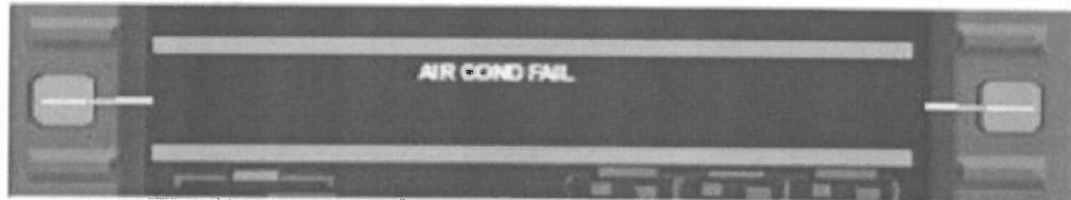
図 0 - 5 : “AIR COND FAIL” - DU に表示される
